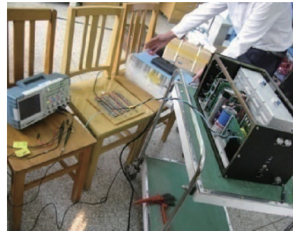
图14 电容器1、2带载对比试验
